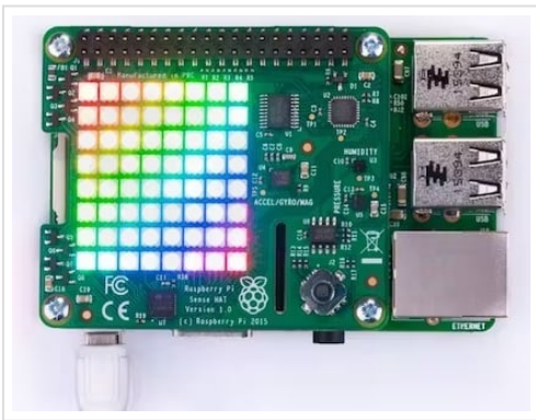
그림 1. SenseHAT의 8x8 RGB LED 매트릭스
