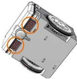
바닥 센서는 근접 센서와 마찬가지로 적외선을 방출하는 IR-LED와 적외선을 감지하는 광 트랜지스터로 이루어져 있다. 다른 점은 IR-LED와 광 트랜지스터가 한 쌍으로 이루어져 좌우 바닥 센서 각각 별도로 구성되어 있다는 것이다. IR-LED가 방출하는 적외선이 바닥에 반사되어 들어오는 광량을 광 트랜지스터가 검출한다.
