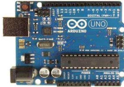
그림 244 아두이노 보드의 모습(Arduino Uno R3)
