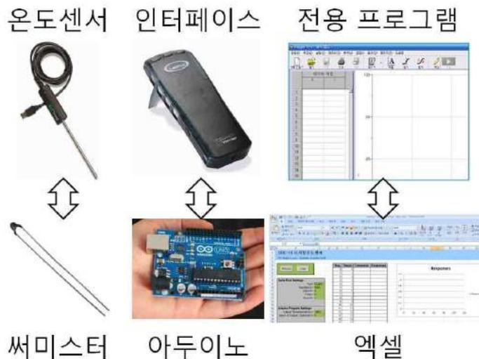
그림 246 MBL의 구성과 아두이노를 이용한 방법의 관계
