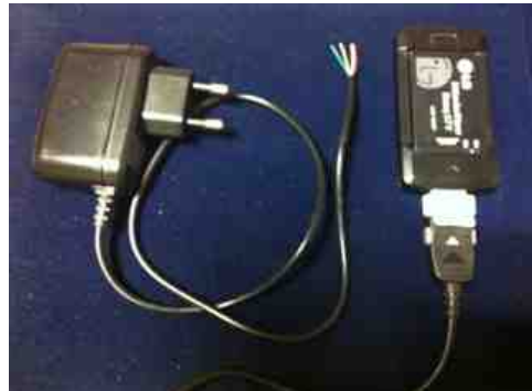
그림 20. 핸드폰 충전기의 어댑터 자르기
