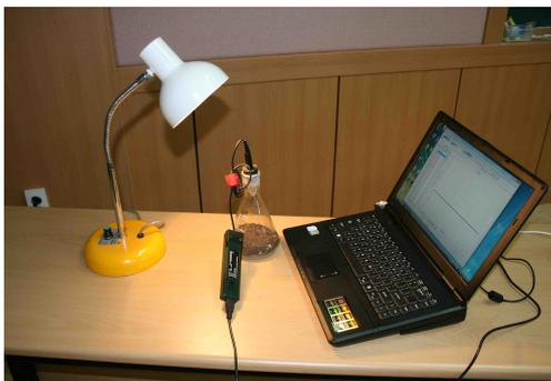
④ 가열한 흑만 넣은 삼각플라스크 (A)와 A와 똑같이 처리하여 CO<sub>2</sub>를 주입한 삼각플라스크 (B)에 백열등을 비추면서 플라스크 내의 온도변화를 디지털온도계나 MBL을 이용하여 측정해 본다.
